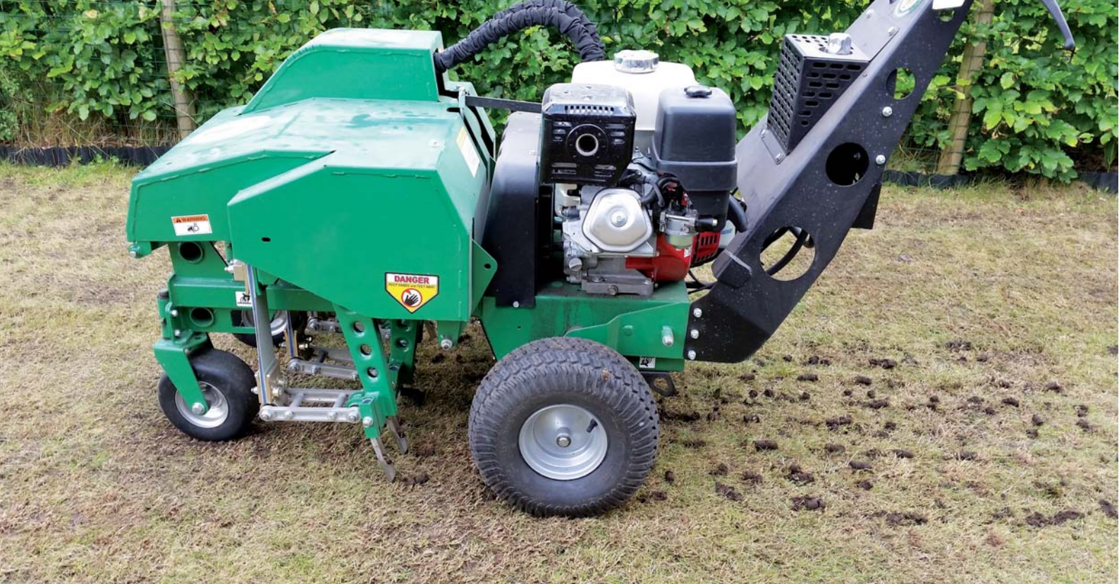
Aeratoren trækker propper op af plænen. Det giver mulighed for at lufte græsset og skifte lidt af jorden. Foto: Gug Anlæg & Planteskole.
